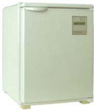
**Термостаты электрические суховоздушные** серии АТ (АТ-1, АТ-2) предназначены для поддержания в рабочем объёме заданной температуры в диапазоне от + 20 °С до + 50 °С (для АТ-2) и + 20 °С (для АТ-1) с отклонением не более  $\pm 0,5$  °С.
